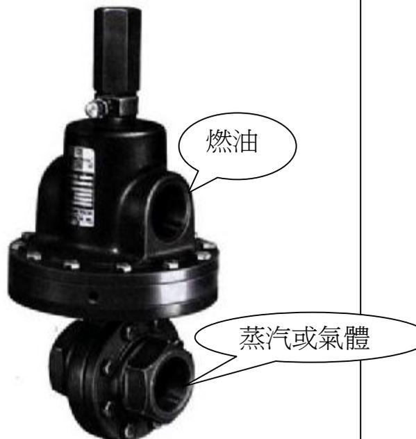
專用於鍋爐燃油之霧化。利用分別隔開的 2 個小室，控制空氣或蒸汽與燃油之固定壓差，來取得最好的霧化效果以達到完全燃燒。
